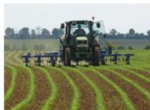
Le matériel utilisé doit être cohérent avec le semoir et adapté à la culture et au type de sol. Il doit être pratiqué sur **plantes adventices jeunes (2 à 4 feuilles maximum) en conditions sèches**. Plus de détails sur les réglages de votre bineuse, consulter la plaquette « Désherbage mécanique en culture de maïs : comment bien choisir son outil ? » (disponible sur <https://aura.chambres-agriculture.fr/>).
